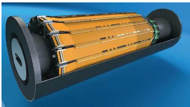
Ansicht des Silizium-Vertex-Detektors von außen. Auf flexiblen Leiterplatten (orange) sind die in einer Reihe angebrachten Verstärker-Chips (schwarz) mitsamt dem darüber liegenden Kühlrohr zu sehen.
